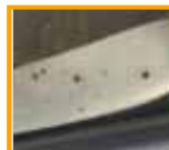
Schere mit Lochkorrosion
