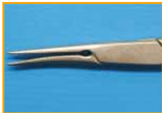
Verformung durch unsachgemäße Handhabung
