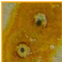
Chloridhaltiges Regeneriersalz führte zu massivem Lochkorrosionsbefall auf der Instrumentenoberfläche. Ursache: undichter Anschluss des Ionenaustauschers im RDG.
