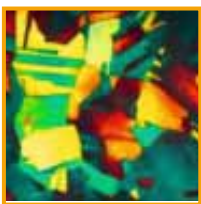
Farbätzung - austenitische Mikrostruktur rost- und säurebeständiger Instrumentenstahl (500-fache Auflösung)
