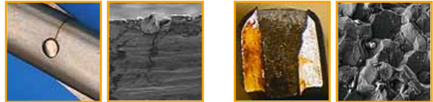
Detail: Schlussgelenk Schere mit typischem interkristallinem Anriss.
