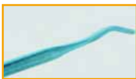
Korrodiertes Füllspatel Ursache: Anbeizung durch sauren Zemententferner
