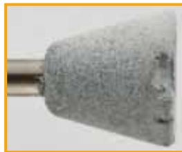
Polierer mit Materialausbrüchen am distalen Ende
