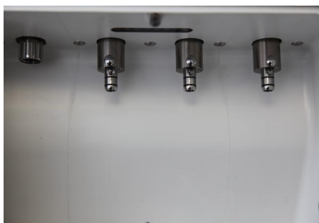
Figure 18 : Version 1 de l'iCare+ avec 1 turbine et 3 connecteurs E-type
