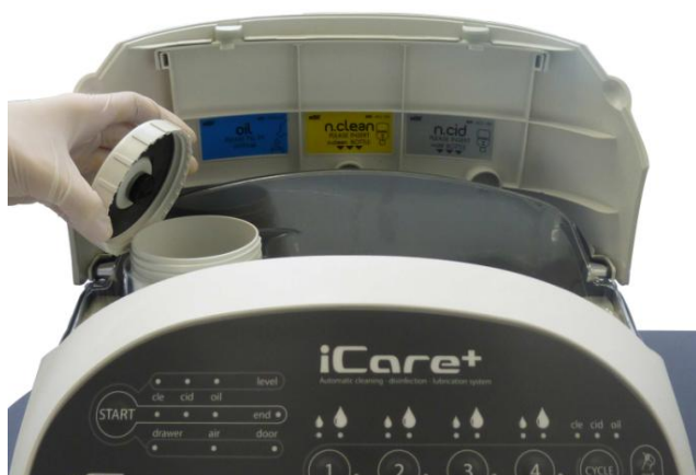
Abbildung 12: Aufschrauben des iCare+ Öltankdeckels
