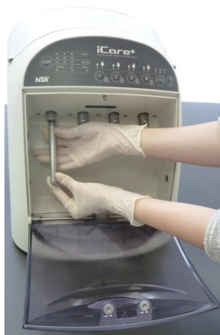
Abbildung 15: Festschrauben des Halterings am Midwest-4-Loch-Anschluss
