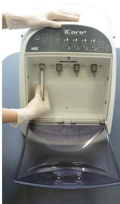
Figure 14 : Connexion au connecteur turbine
