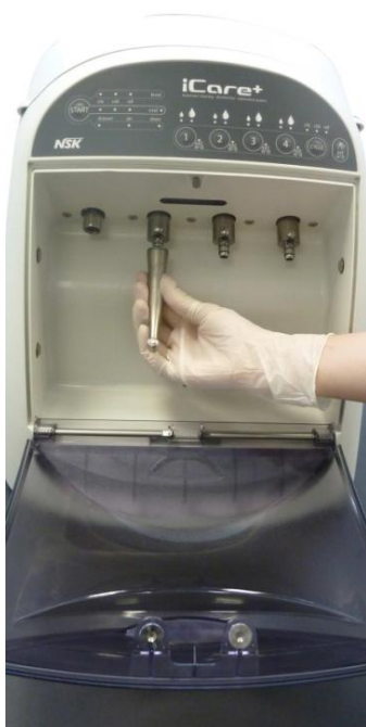
Abbildung 17: Anschluss eines Hand-/Winkelstücks
