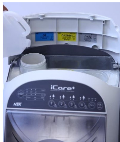
Abbildung 13: Befüllen des iCare+ Öltanks
