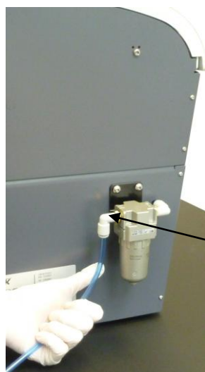
Figure 6 : Connexion du tube au système pneumatique de l'appareil iCare+
