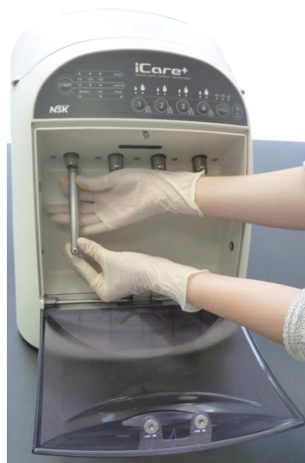
Figure 15 : Vissage de la bague sur le raccord Midwest
